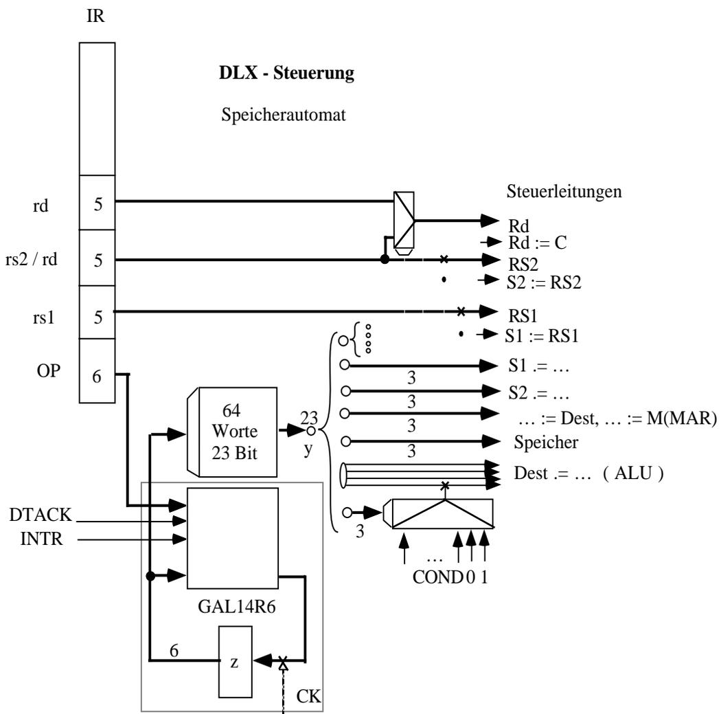
Im Prinzip können beide, der Speicher und das Schaltnetz, durch GAL's (gate array logic) realisiert werden. Wie oben gezeigt, kann das Schaltnetz und das Zustandsregister durch ein einziges GAL mit 14 Eingängen und 6 Ausgängen realisiert werden. Die Methoden zur Vereinfachung der Schaltnetze sind hier nicht Gegenstand der Untersuchung.
