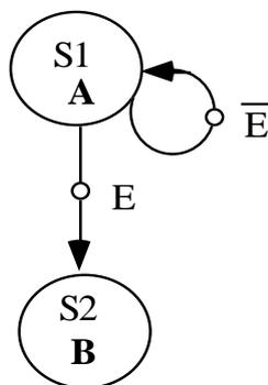
Bei Vorliegen der Weiterschaltbedingungen E im Zustand S1 wird nach S2 geschaltet.
