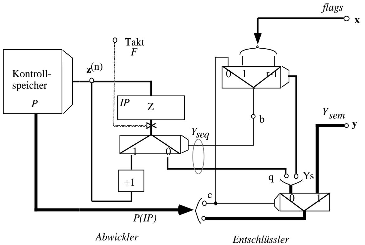
Vertikale Mikroprogrammierung und Programmsteuerung einer Wegener-Maschine sind äquivalent.
