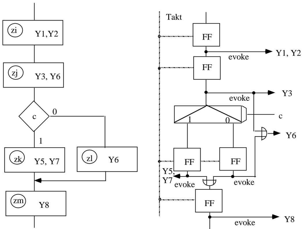
Werden die gleichen Steuerleitungen in mehr als einem Zustand aktiviert, sind sie mit ODER-Gattern zu verschalten.
