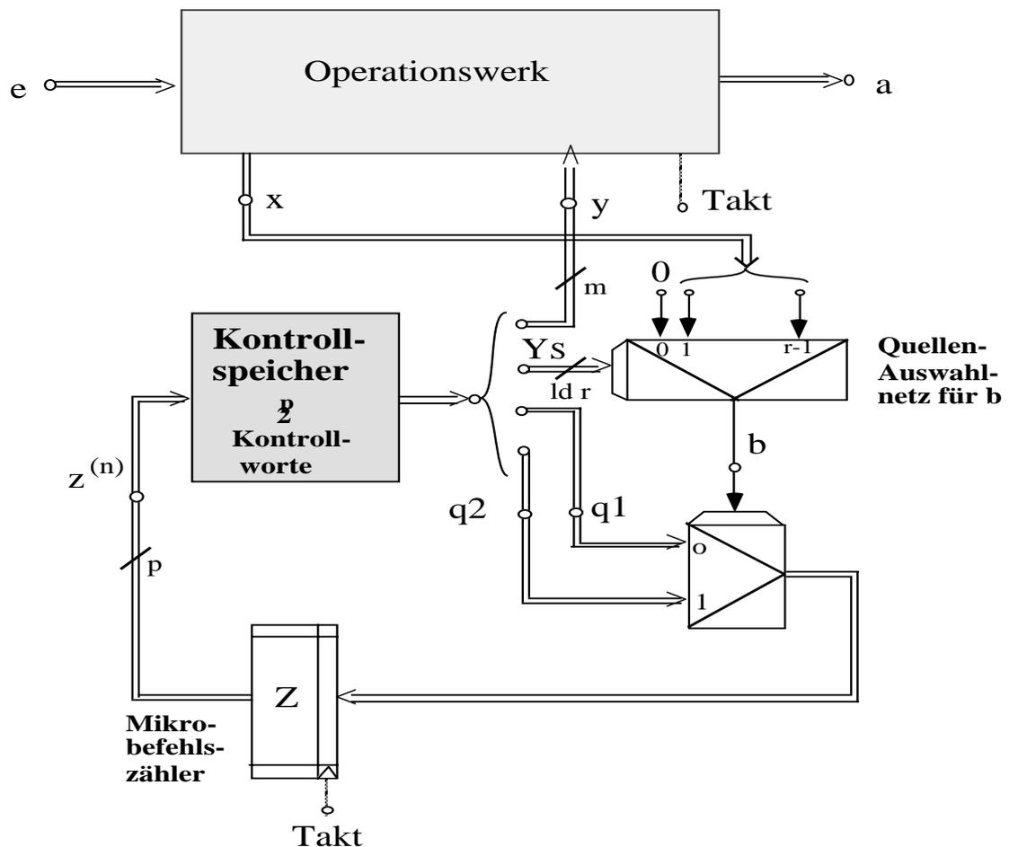
Der Fall, daß keine Bedingungsleitung ausgewählt wird, d. h. der Folgezustand unabhängig von  $x$  ist, wird durch die "0" berücksichtigt.
