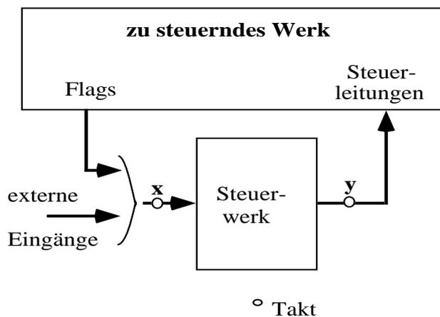
Das zu steuernde Werk erwartet Steuersignale und stellt Flags für Abfragen bereit. Das Steuerwerk hat als Eingänge diese Flags und zusätzliche Signale von außen, die zusammen den Eingangsvektor  $\mathbf{x}$  bilden. Es stellt dem zu steuernden Werk den Vektor  $\mathbf{y}$  der Steuerleitungen zur Verfügung.
